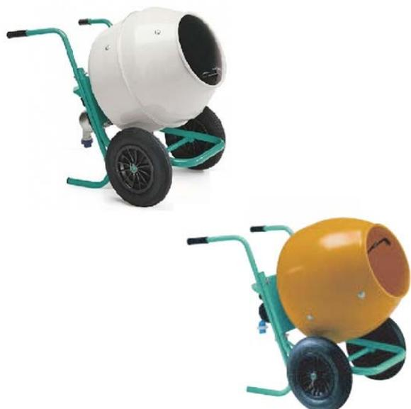
Ambas de transmisión directa. Capacidad total cuba de amasado 136 l. Capacidad de amasado 110 l. Motor eléctrico monofásico de 0,5 CV. Máxima fiabilidad y silenciosidad posibilitada por su transmisión directa mediante reductor de acero en baño de aceite.
